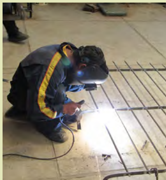
Schlosser-Lehrling beim Schweißen eines Gitters
